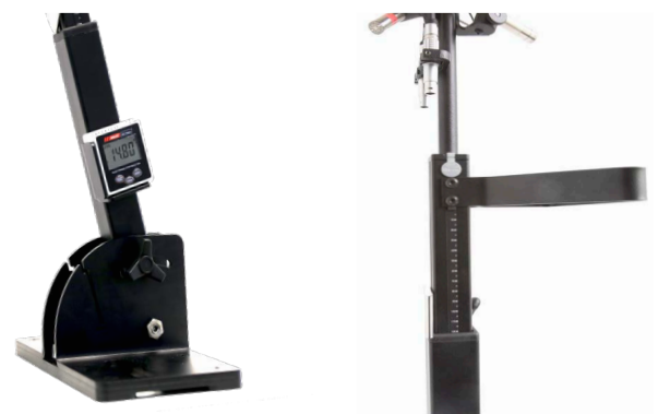
Abbildung 5 Einstellbarkeit von Winkel und Höhe des Mikrofonarrays.
